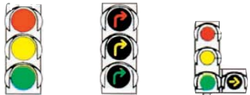
a) de forme circulaire, b) en forme de flèche, Flèche supplémentaire associée aux feux tricolores PRIORITÉ AUX PIÉTONS
