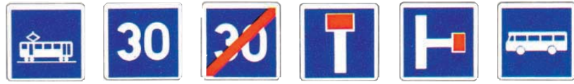
Arrêt de tramway, Vitesse conseillée, Fin de vitesse conseillée, Chemin sans issue, Présignalisation d'un chemin sans issue, Arrêt d'autobus
